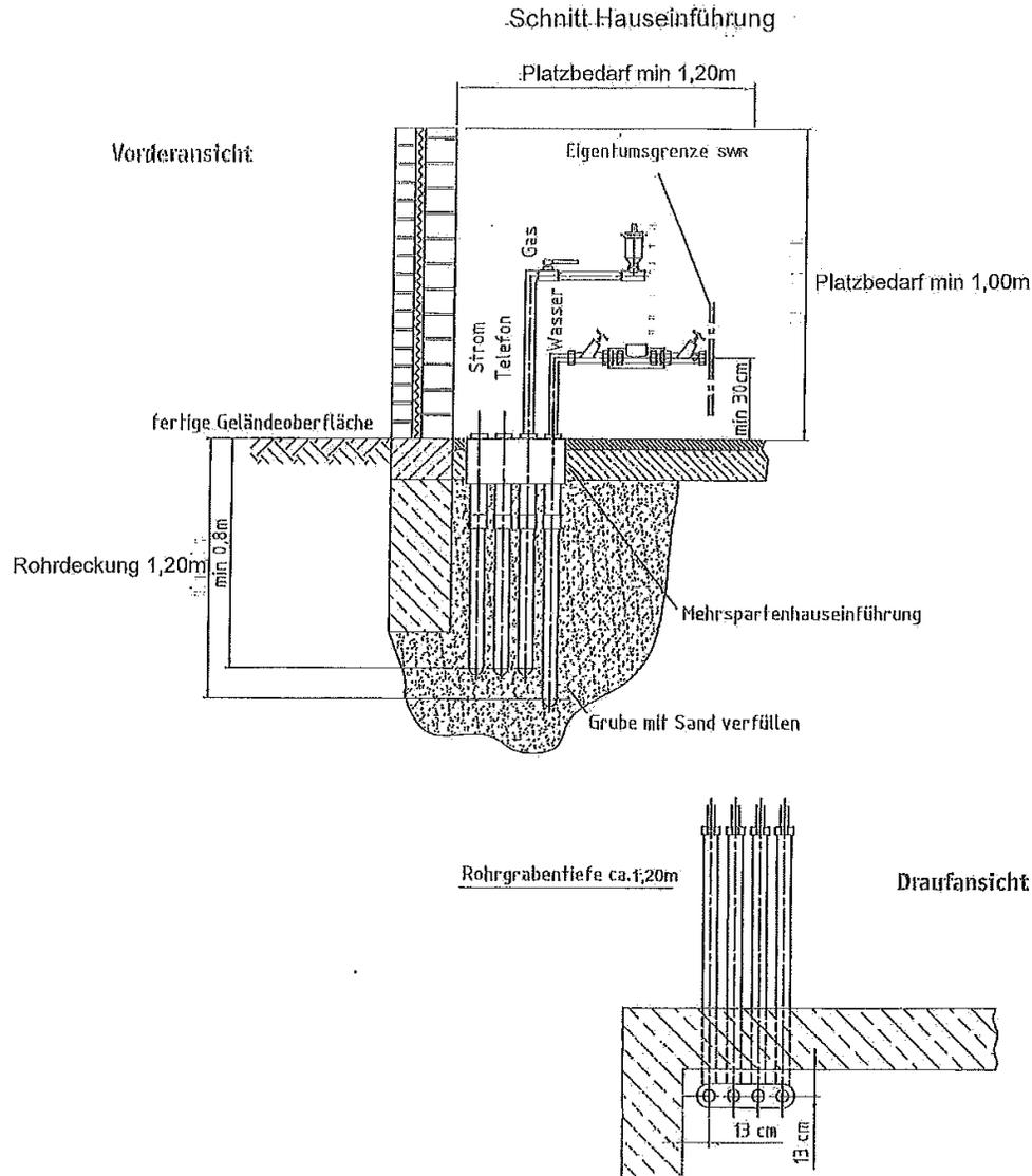
Die Wasserzähleranlage ist an einem jederzeit zugänglichen Ort, unmittelbar nach der Hauseinführung zu installieren. Sie darf nicht verbaut werden, muss vor Frost und ggf. Vandalismus geschützt werden.
